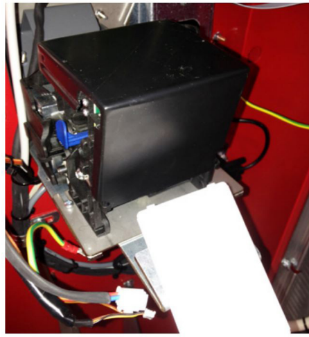
1 – Sollevare la testina della stampante premendo la leva blu, quindi rimuovere la carta dalla parte posteriore della stampante.
