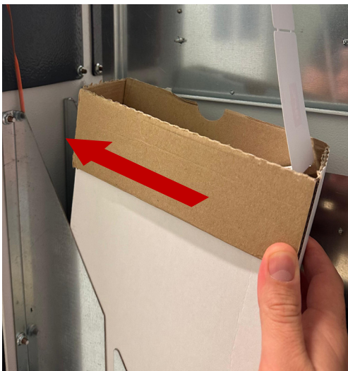
5 – Porre il nuovo pacco dei ticket nell'apposito supporto della stazione.
