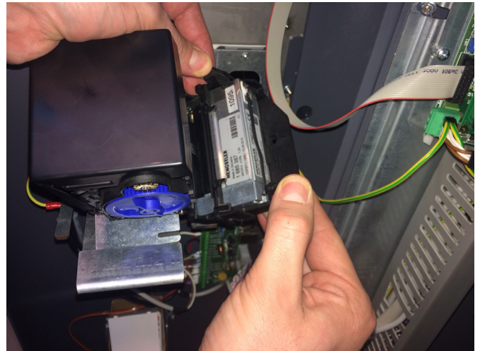
3 – Prima di iniziare la manutenzione, procurarsi dell'aria compressa priva di oli ed un panno antistatico. Agire sulle due alette laterali, aprire la stampante e pulire la parte interna dell'unità.
