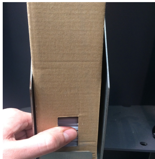
6 – Spingere i ticket dalla fi nestra della confezione, per un corretto funzionamento della fotocellula.
