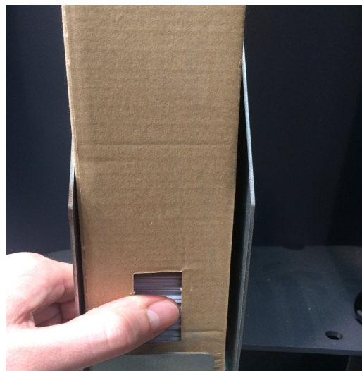
6 – Spingere i ticket dalla fine sinistra della confezione, per un corretto funzionamento della fotocellula.
